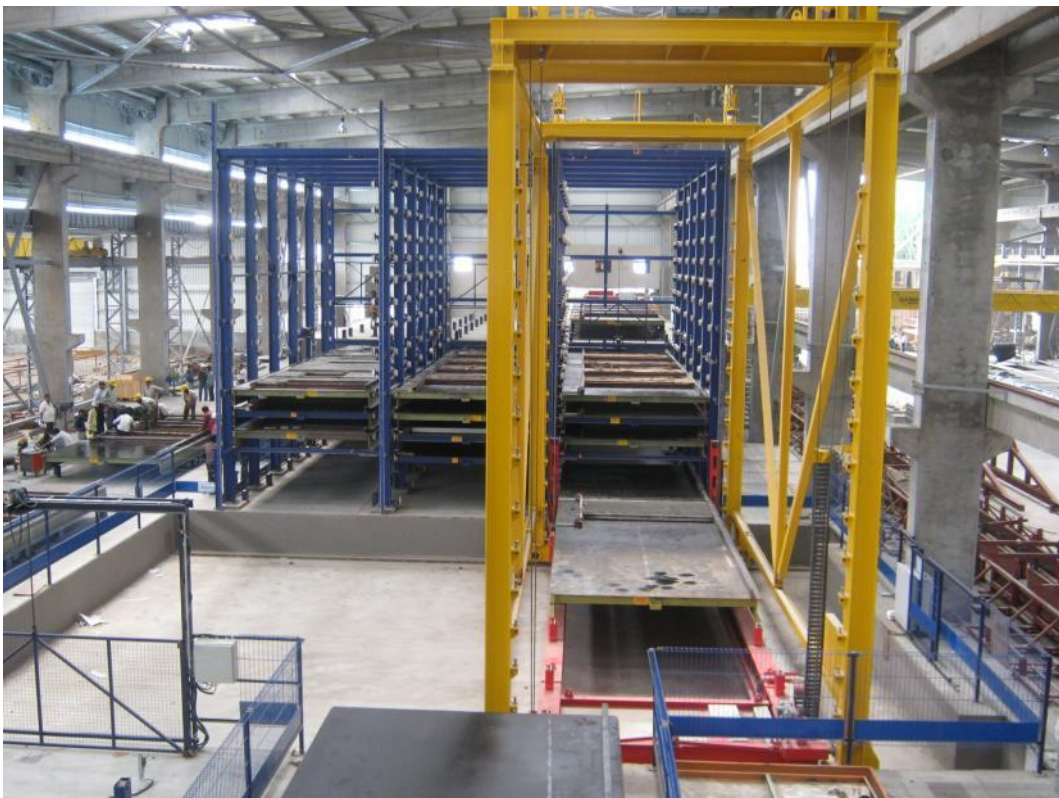
Fig. 12: Aparato de servicio de estantes para introducir y retirar las paletas de la cámara de curado
