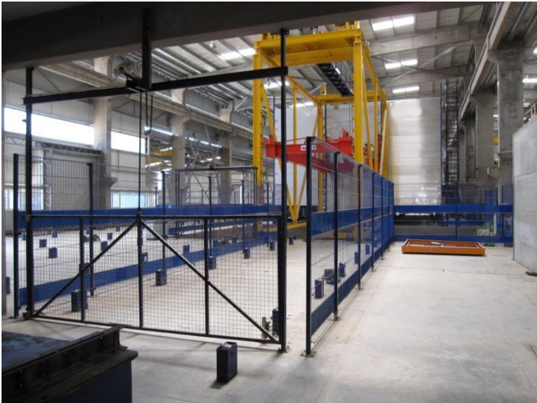
Fig. 14: La cámara de curado consta de tres torres de estantes con 14 compartimentos para paletas cada una superpuestos
