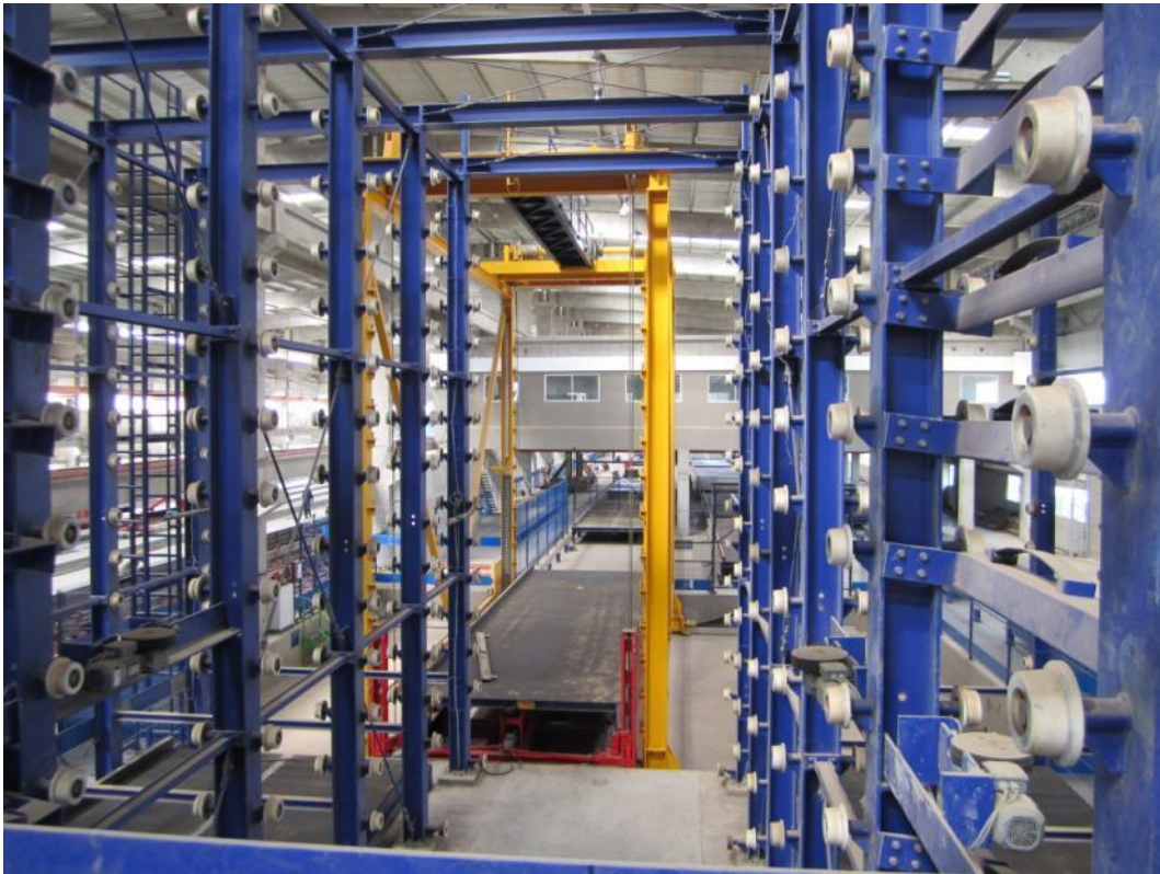
Fig. 13: Las paletas se introducen y se retiran mediante ruedas de fricción y un desplazador de barra dentada
